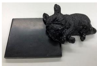
FADPとセルロース粉末の複合化例 (試験片と犬の置物)
