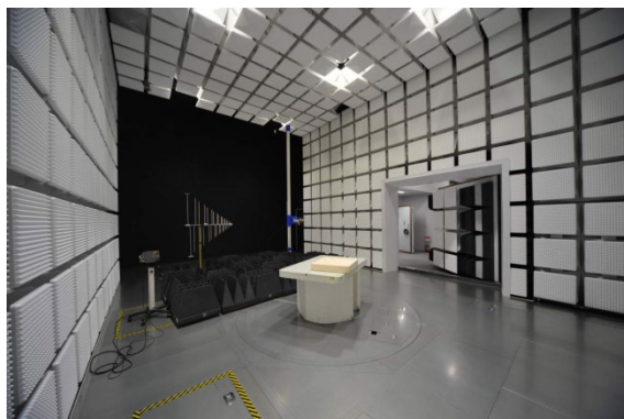
第二電波暗室(放射イミュニティ試験用試験室)
