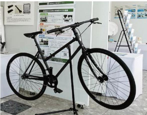
CFRP部品を用いた自転車試作品
