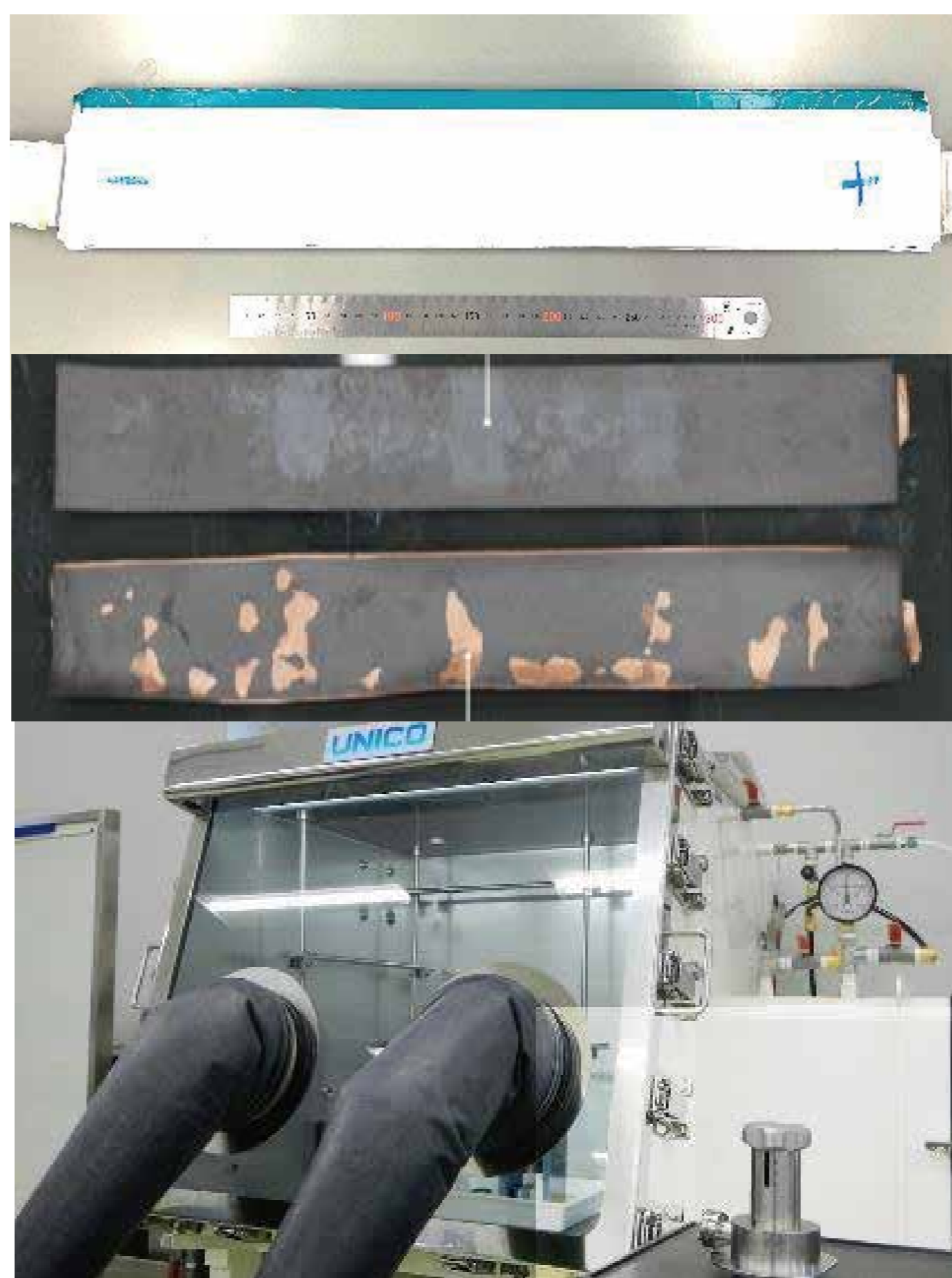
電池パックの外観と内部(上・中) 大気非曝露表面分析用装置(下)
