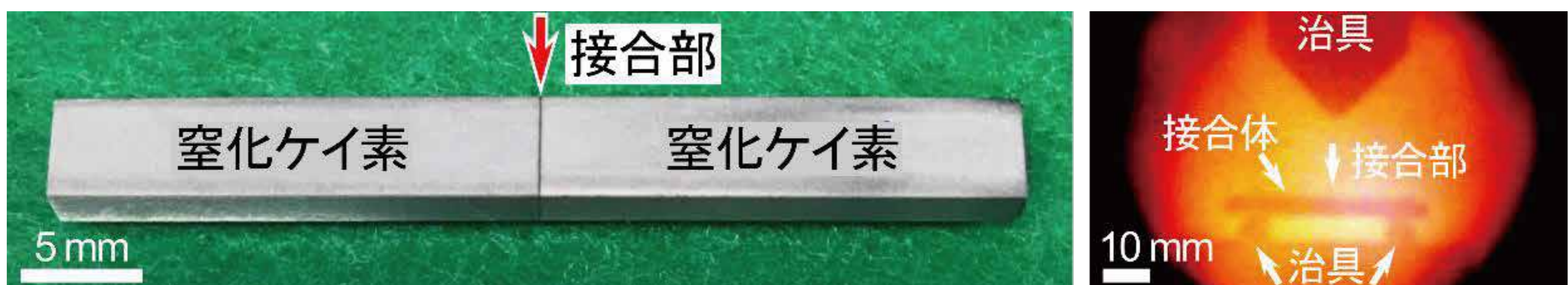
Si+Mgフィラーを用いて1100℃で接合した窒化ケイ素接合体と大気中1200℃での3点曲げ試験の様子
