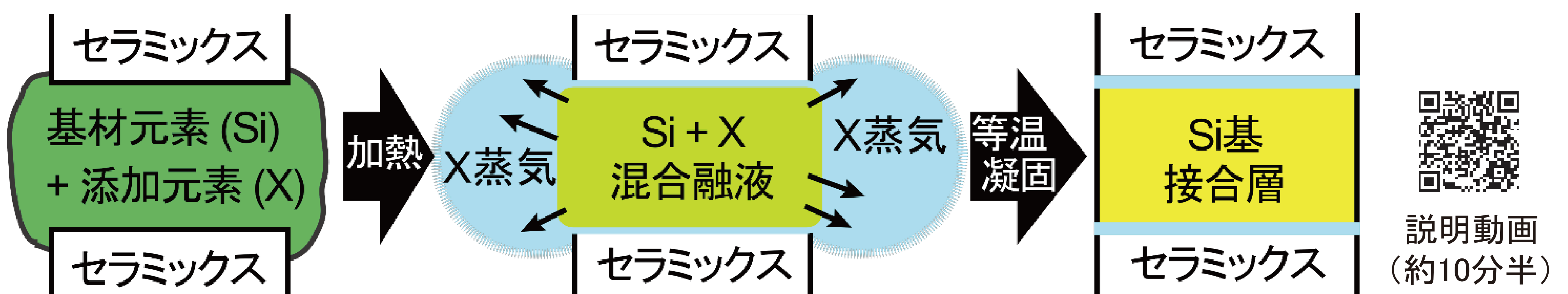
Si基フィラーによるセラミックスの接合 (X = Mg、Ca などの蒸気圧の高い元素)
