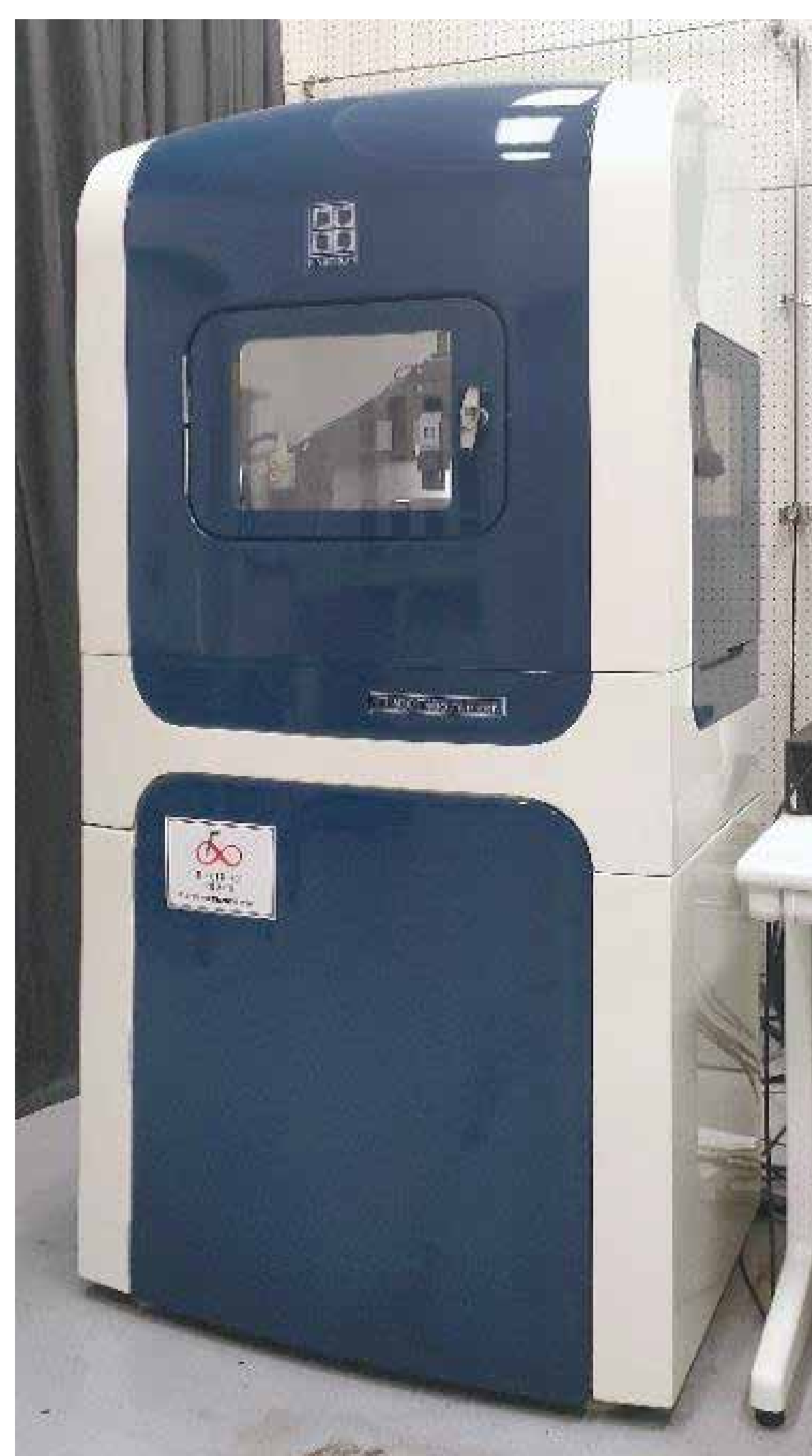
ナノインデントァーの外観 (ハイジトロン社製 TI950)
