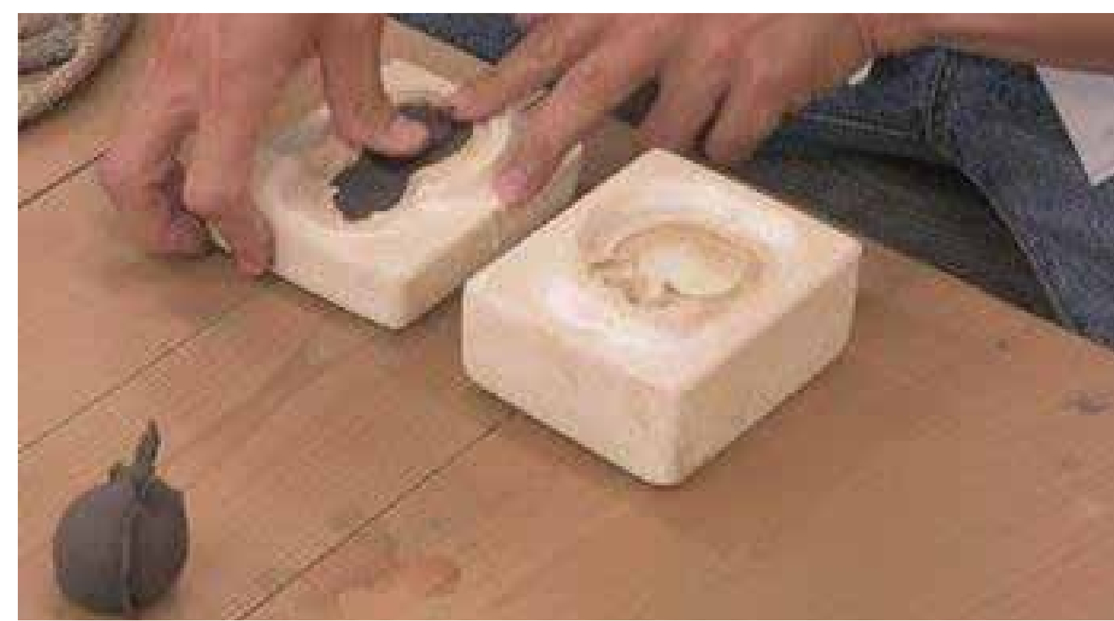
作成した使用型による粘土成形
