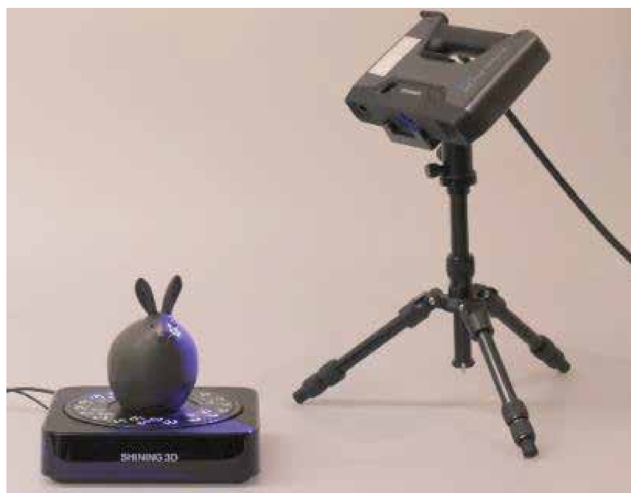
3Dスキャナーによるデジタルデータ化 および3D CAD/CAMによる加工データの作成
